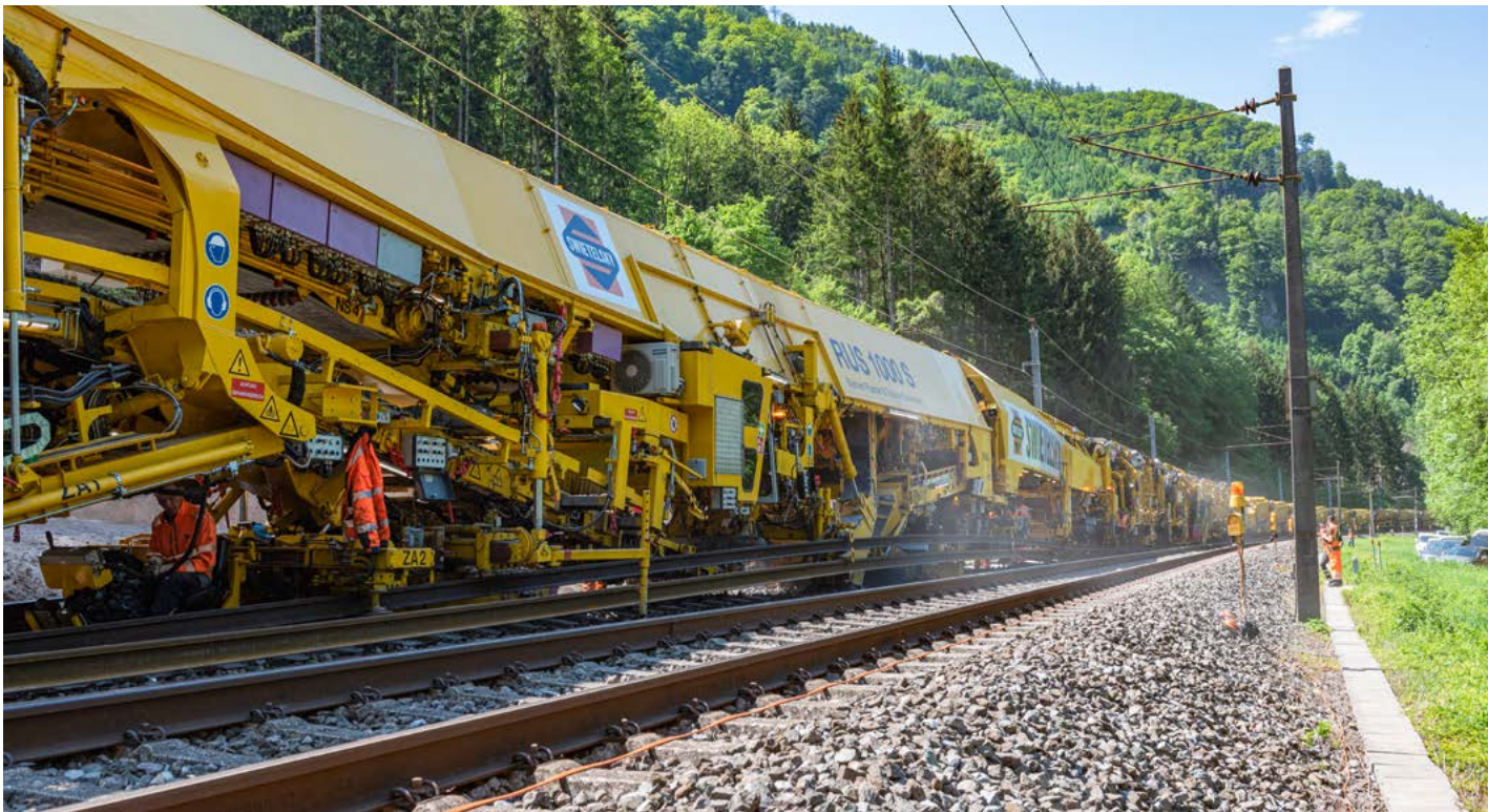
Gleisumbau und Schotterbettreinigung RUS 1000 S, Frohnleiten, Österreich
